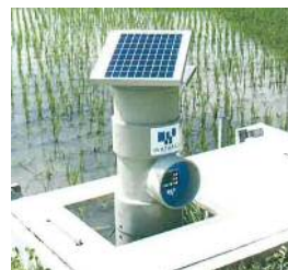
自動給排水栓で遠隔操作
